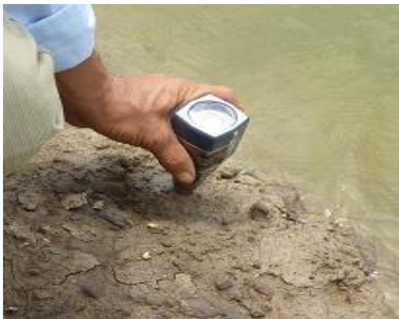
Hình 23.02.01: Cắm thiết bị đo pH xuống đất
